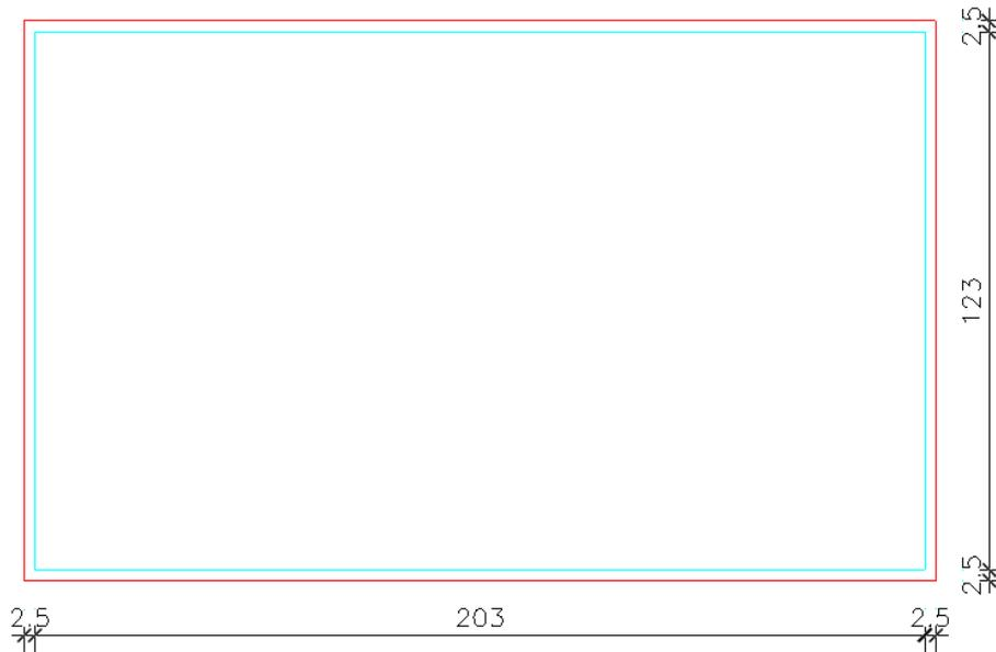
2- Faça um “presspull” no interior do desenho azul, do passo 1, com uma altura de 1cm e faça um “presspull” na região entre o desenho vermelho e o desenho azul, também do passo 1, com uma altura de 2cm;
